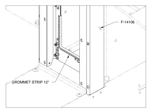
FIGURE 1: GROMMET STRIP INSTALL
